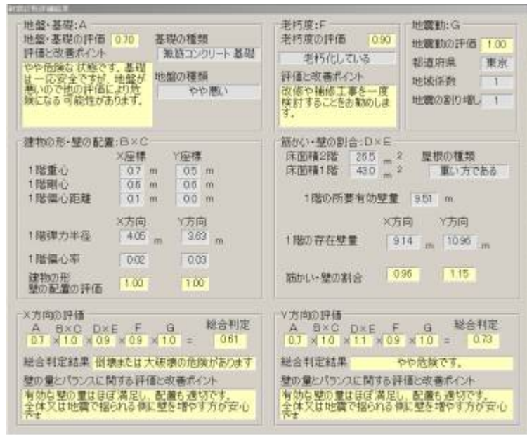
図 5.3-18 木造建物の簡易耐震診断ソフトの結果表示画面
