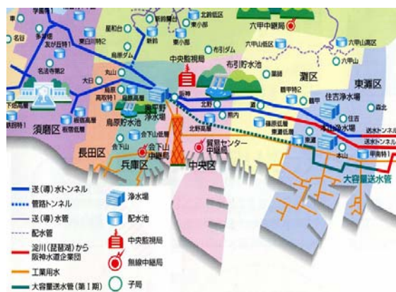
図1.4-1 神戸市水道局の上水道システム 2)
